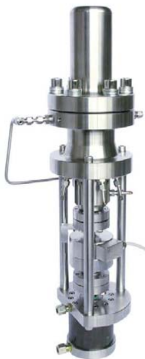
Autokláv pro hodnocení vlastností materiálu za provozních parametrů
