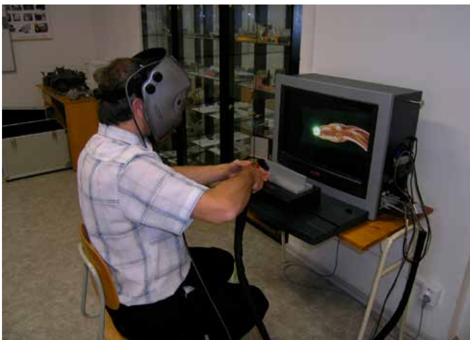
Obr. č. 1 Virtuální simulátor svařování
