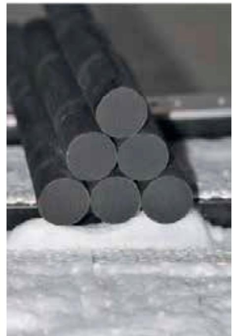
Abb. 7: Module der Füllung der einzelnen Segmente des Adsorptionskreises
