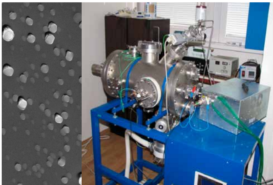
Obrázek 3: Vlevo nanočástice SnO připravené plazmovou depozicí jako senzory plynů. Vpravo plazmový reaktor na Přírodovědecké fakultě UJEP.
